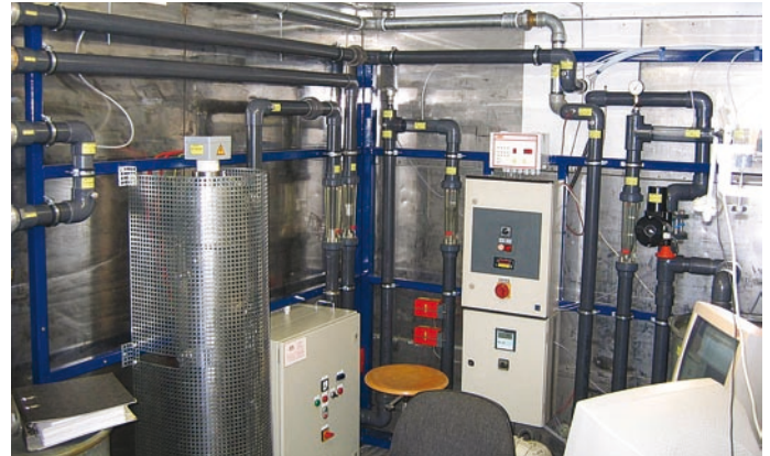
Bild 2: BTEX-, CKW- und Methan-Abbau, chemische Industrie, Deutschland, 250 m³/h, 8400 mg/m³
