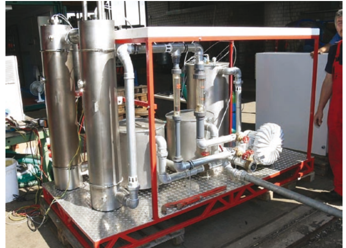
Bild 8: Pilotanlage für 100 bis 1000 m 3 /h Abluft
